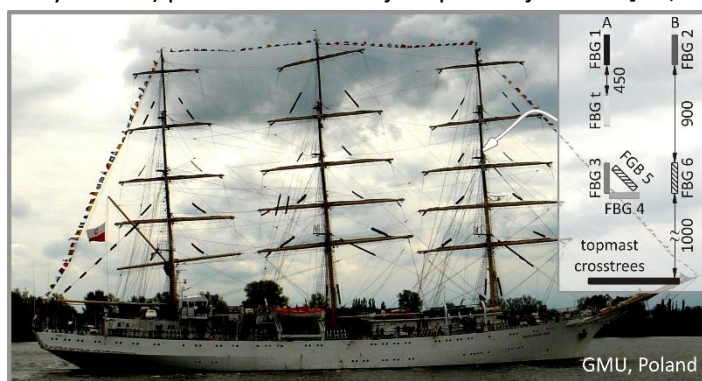
Rys. 1. STS Dar Młodzieży z zaznaczonym miejscem montażu i układem czujników światłowodowych typu FBG powyżej platformy saling, [H2].
