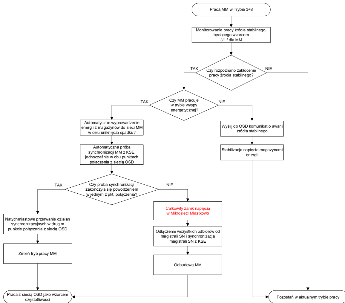
Rysunek 53. Schemat blokowy działania Mikro sieci Miastkowo w Trybie 6
