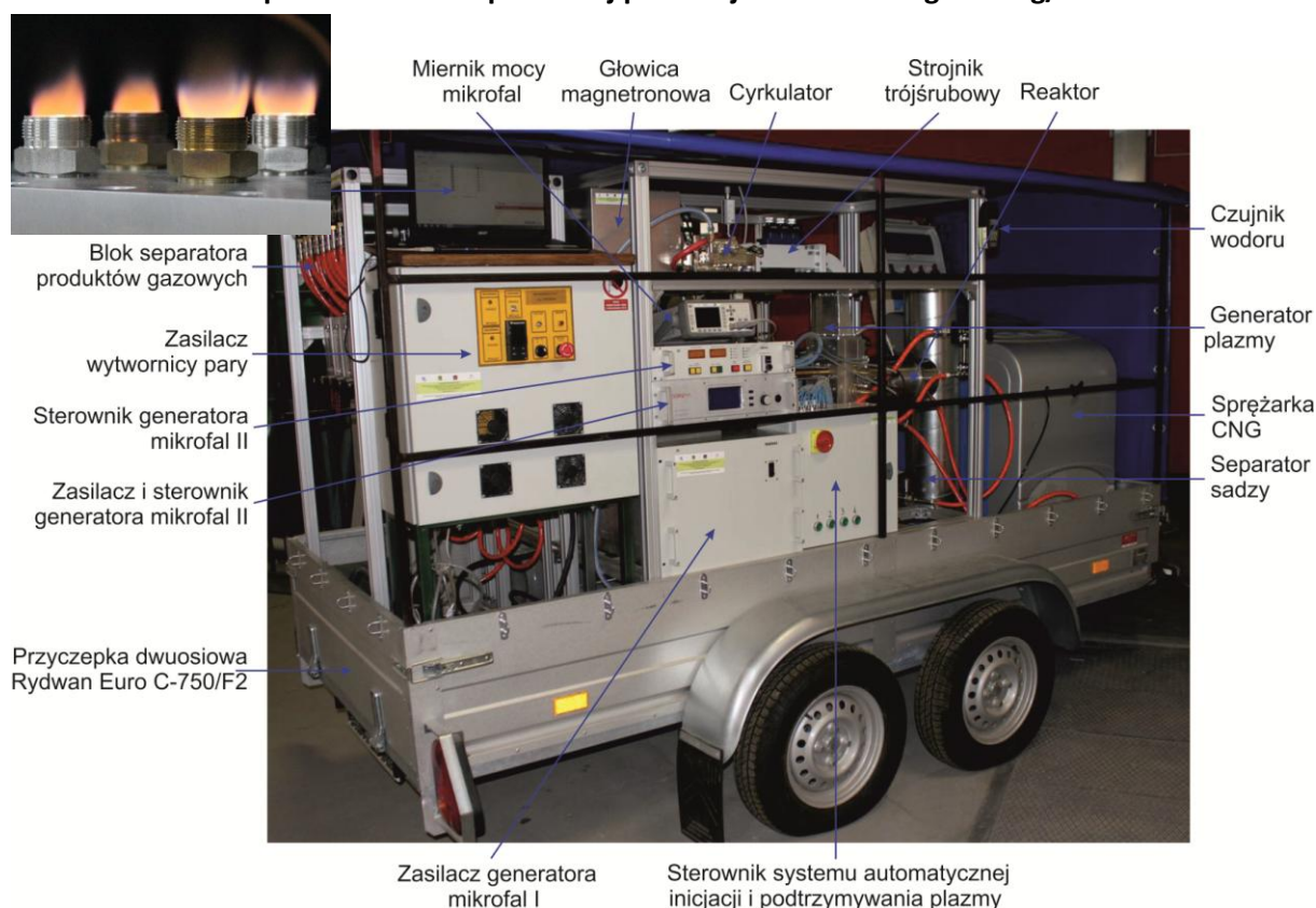
Układu do rozproszonej produkcji wodoru z biogazu 7 kg/h wykorzystujący palniki mikrofalowe (górny lewy róg)
