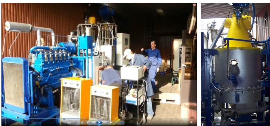
Układ kogeneracyjny (a) ze zgazówką o mocy cieplnej 180 kWc (b), wartość opałowa syngazu - \sim 5 \text{ MJ/Nm}^3 , natężenie przepływu gazu – 140 \text{ Nm}^3/\text{h}
